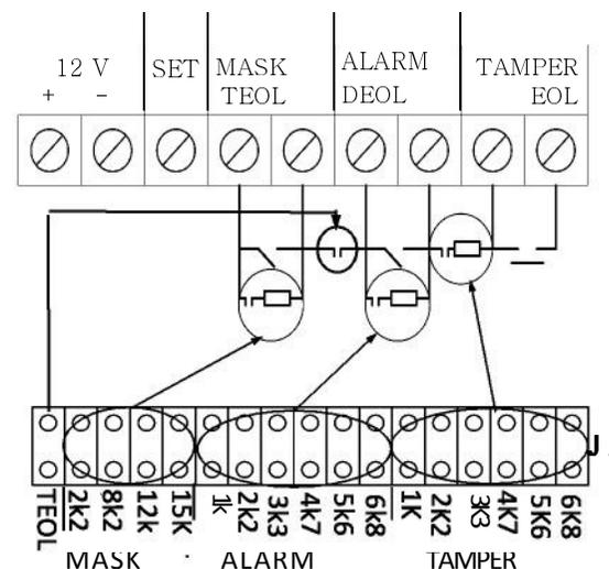
**NB: Lasciando i ponticelli aperti come da fabbrica il NIM15 rimarrà configurato come un qualsiasi sensore con contatti NC**
